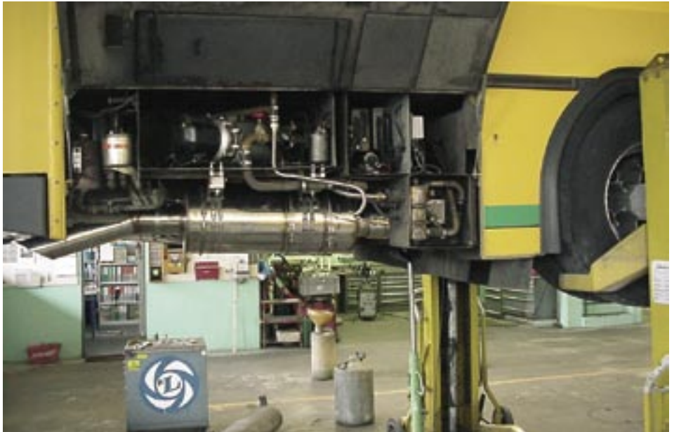
Nachrüstung eines Dieselbusses mit einem Partikelfilter. Im Inland haben die öffentlichen Verkehrsbetriebe bereits hunderte von Fahrzeugen mit diesem effizienten Abgasreinigungssystem ausgestattet.
